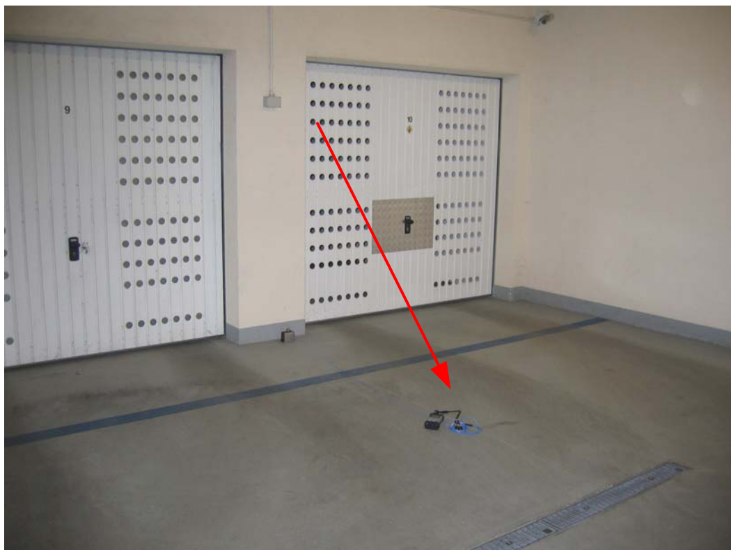
Zdjęcie 2-3 Pomiary drgań wewnątrz budynku (punkt D1)
