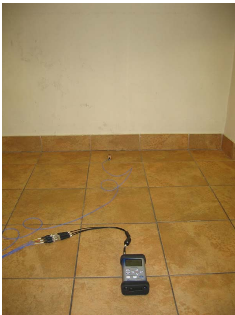
Zdjęcie 2-1 Pomiary drgań wewnątrz budynku (punkt D1)
