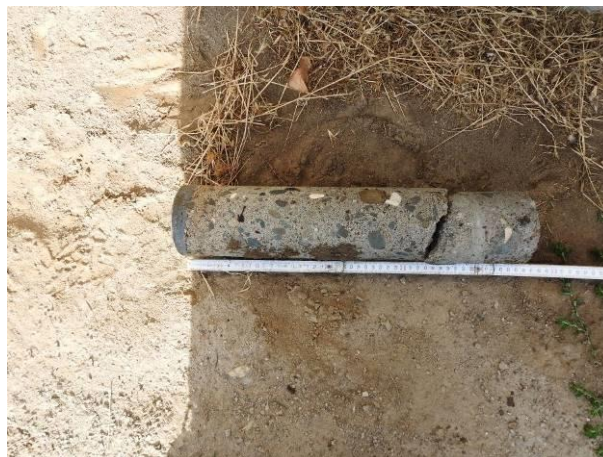
Fot. 4.3 Na zdjęciach powyżej przedstawiono przykładowe zdjęcia z poboru rdzeni betonowych z podpory od strony zachodniej (nr 2).
