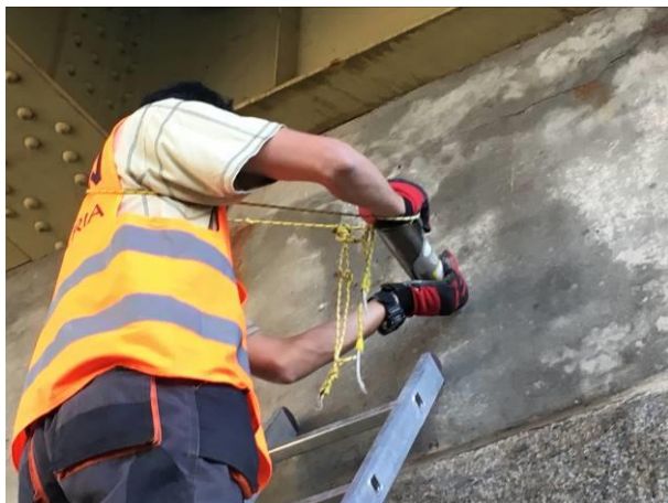
Fot. 4.1. Na zdjęciach powyżej przedstawiono wykonanie badania młotkiem Schmidta
