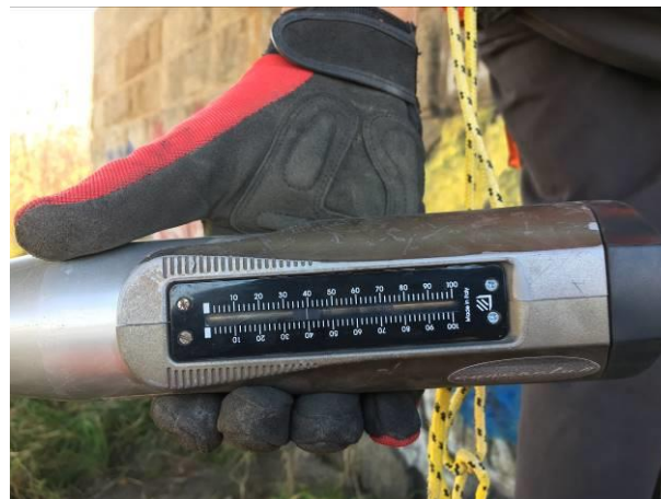
Fot. 4.1. Na zdjęciach powyżej przedstawiono wykonanie badania młotkiem Schmidta
