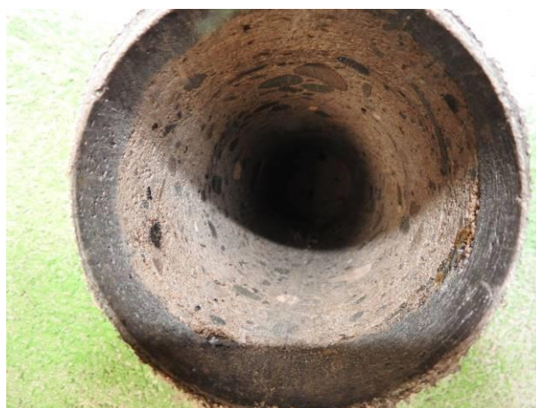
Fot. 4.4 Na zdjęciach powyżej przedstawiono przykładowe zdjęcia z poboru rdzeni betonowych z podpory od strony wschodniej (nr 1).
