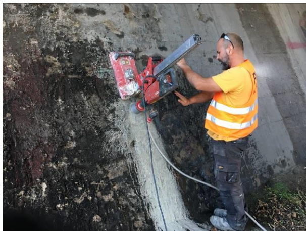
Fot. 4.3 Na zdjęciach powyżej przedstawiono przykładowe zdjęcia z poboru rdzeni betonowych z podpory od strony zachodniej (nr 2).
