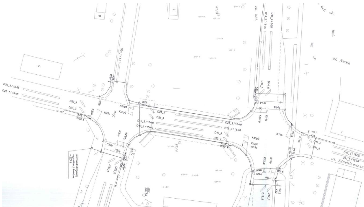
Schemata nr 7 kanalizacja sygnalizacji świetlnej Wrocławska Czyżewskiego
